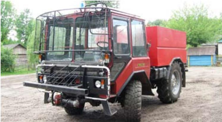
*Фото. Машина лесопожарной охраны первого хода МЛ-10(356), на базе шасси тракторного универсального «Беларусь» ШУ-356.*
